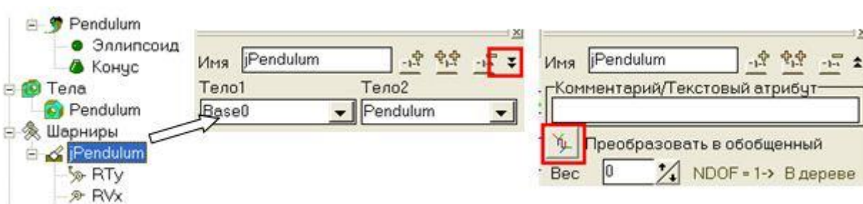
Рис. 7.50. Преобразование вращательного шарнира к обобщенному типу
