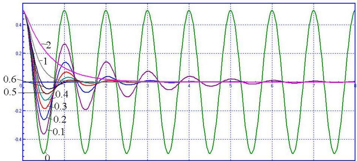
Рис. 7.2. Процесс затухания при различных значениях доли демпфирования от критического
