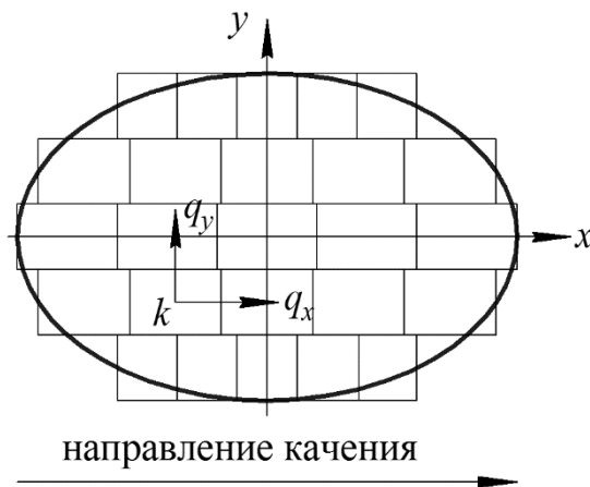
Рис. 8.99. Дискретизация пятна контакта на элементы
