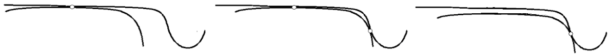
Рис. 8.89. Типы контактов пары профилей, допускающих двухточечный контакт: одноточечный контакт, двухточечный контакт и режим вкатывания
