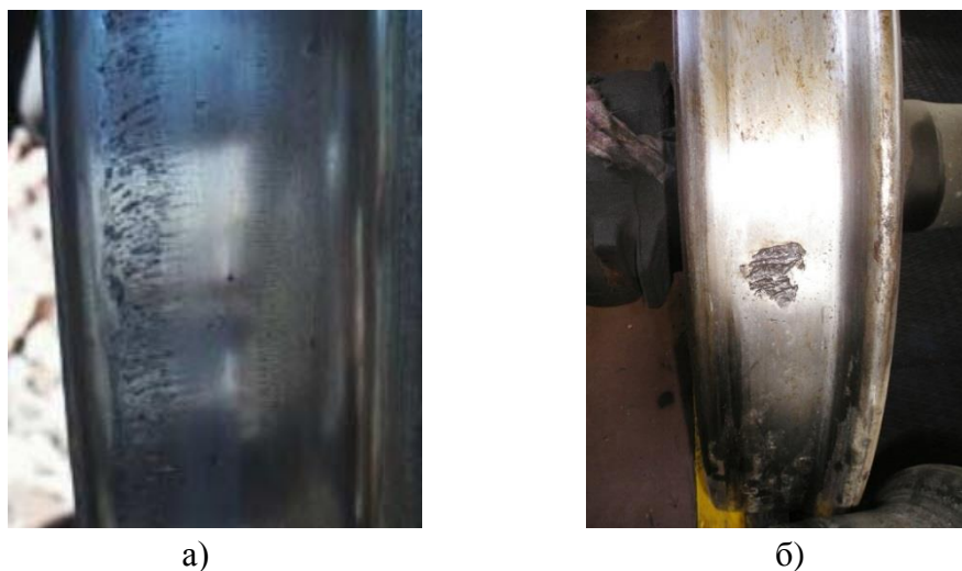
Рис. 1.2. Контактно-усталостные повреждения колеса: а – поверхностные; б – подповерхностные
