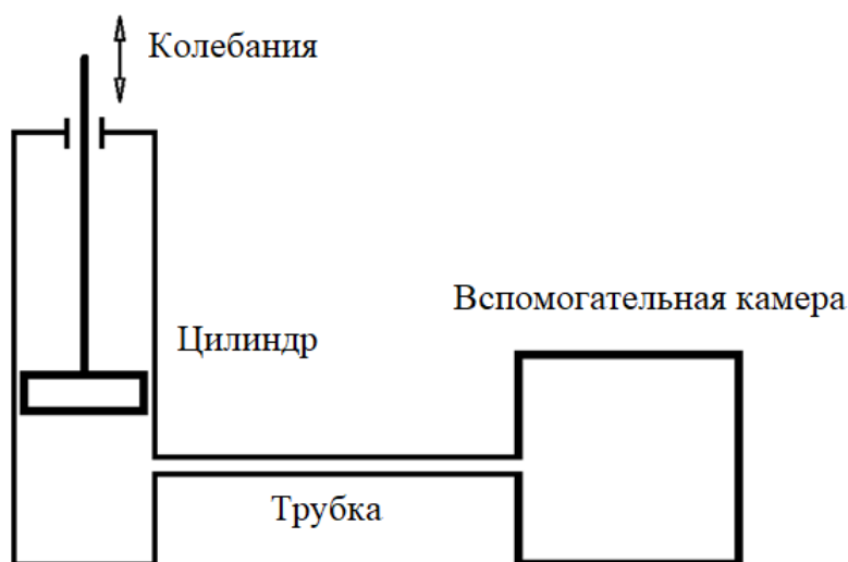
Рис. 31.81. Схема эксперимента для изучения влияния трубки на динамическую жесткость и демпфирование пневморессоры со вспомогательной камерой
