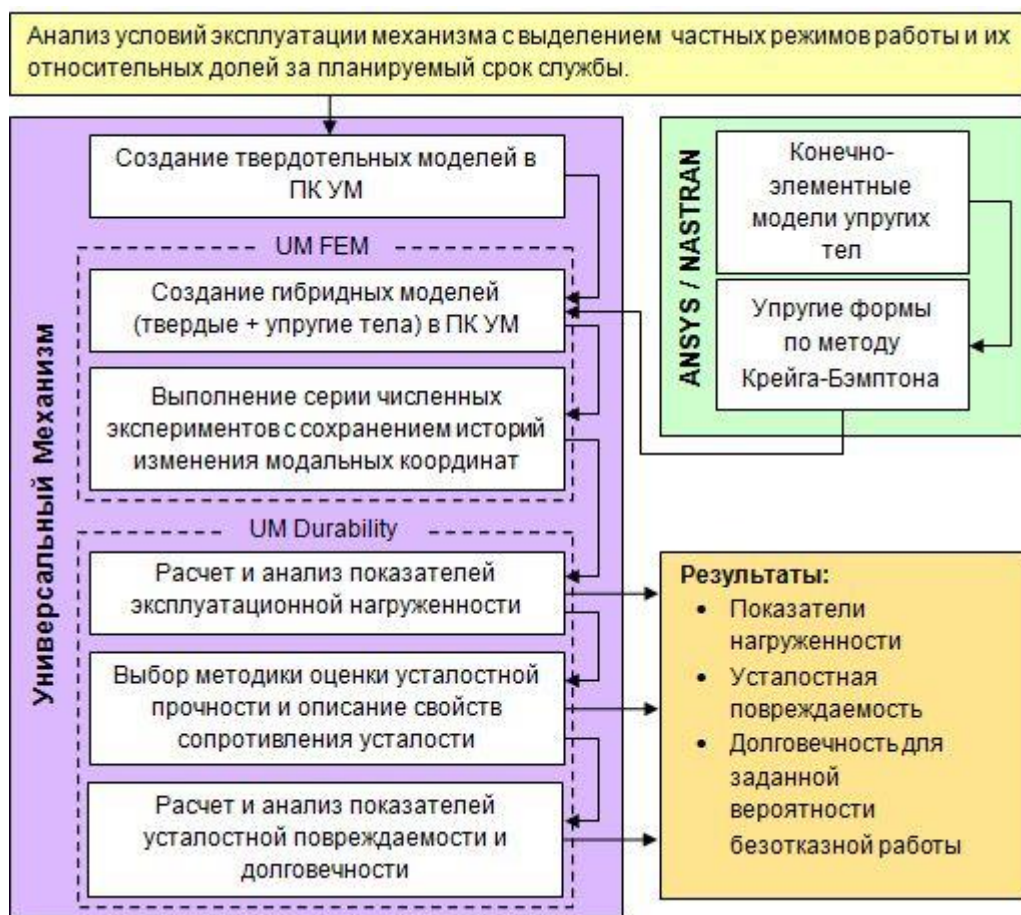
Рис. 1.1. Методика анализа эксплуатационной нагруженности и усталостной долговечности, реализованная в ПК УМ.
