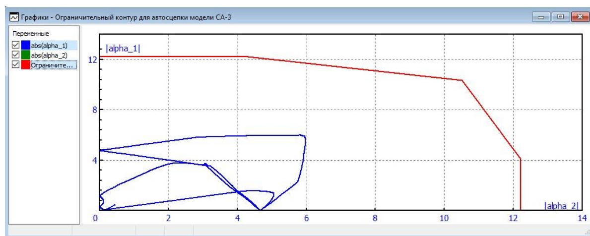
Рис. 13. Оценка обеспечения прохода сцепа из двух проверяемых вагонов в S-образной кривой
