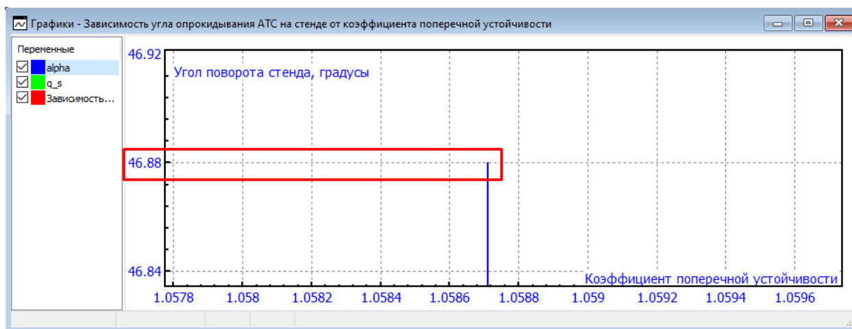
Рис. 23. Определение угла поворота платформы в момент опрокидывания АТС
