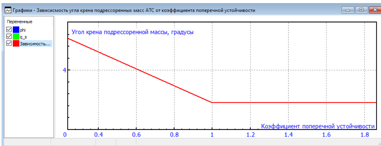
Рис. 15. Графическое окно с графиком предельно допустимых значений угла крена \varphi_H
