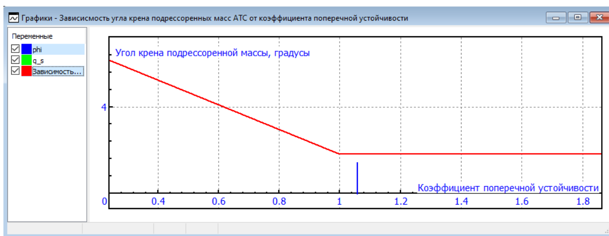
Рис. 24. Оценка угла крена подрессоренных масс \varphi относительно предельно допустимого значения \varphi_H
