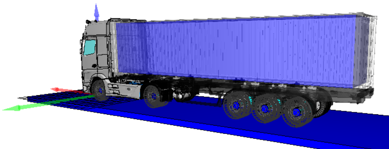
Рис. 32. Модель груза в трёхосном бортовом полуприцепе
