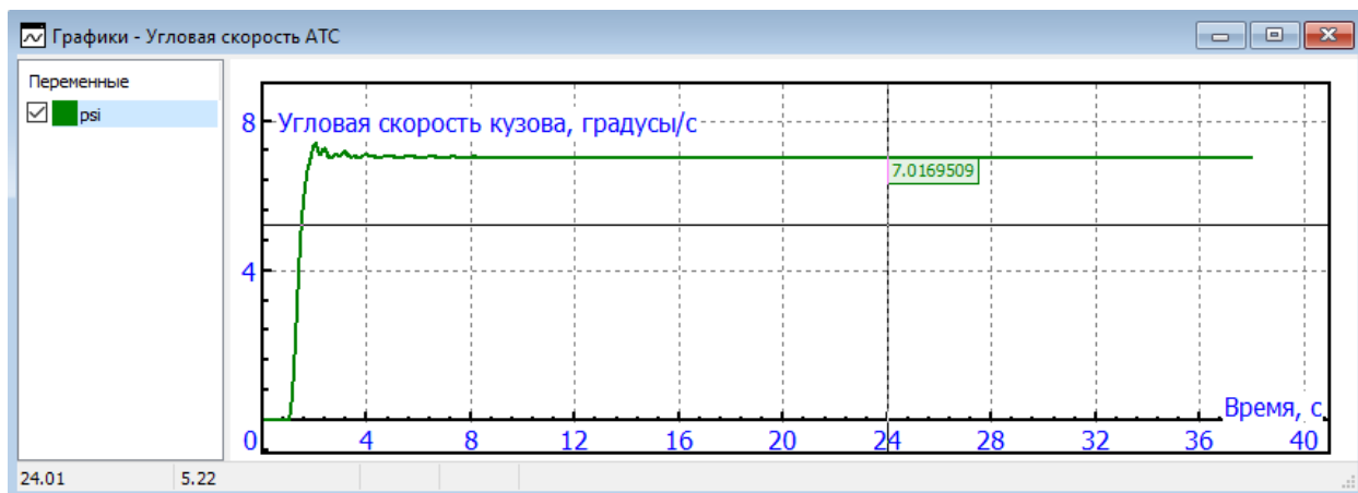
Рис. 16. Определение установившегося значения угловой скорости \psi
