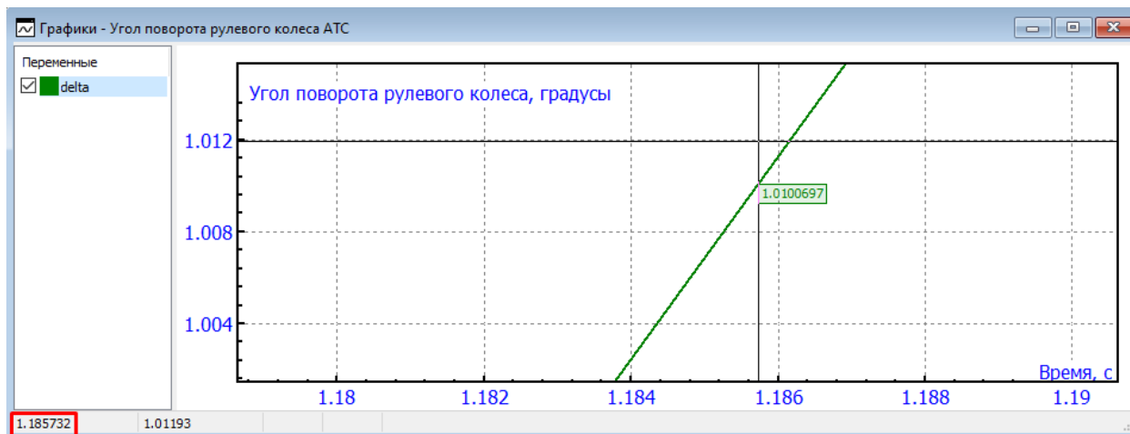
Рис. 20. Определение времени t_{\delta_{50\%}}
