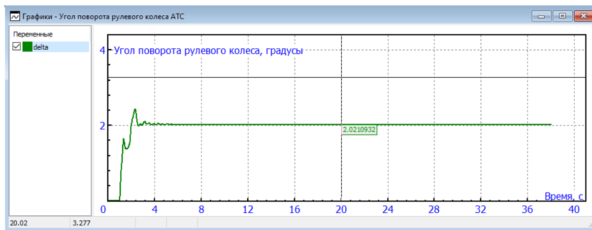
Рис. 19. Определение установившегося значения угла поворота рулевого колеса \delta_n
