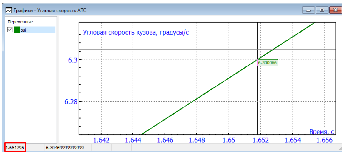
Рис. 18. Определение времени t_{\psi_{90\%}}
