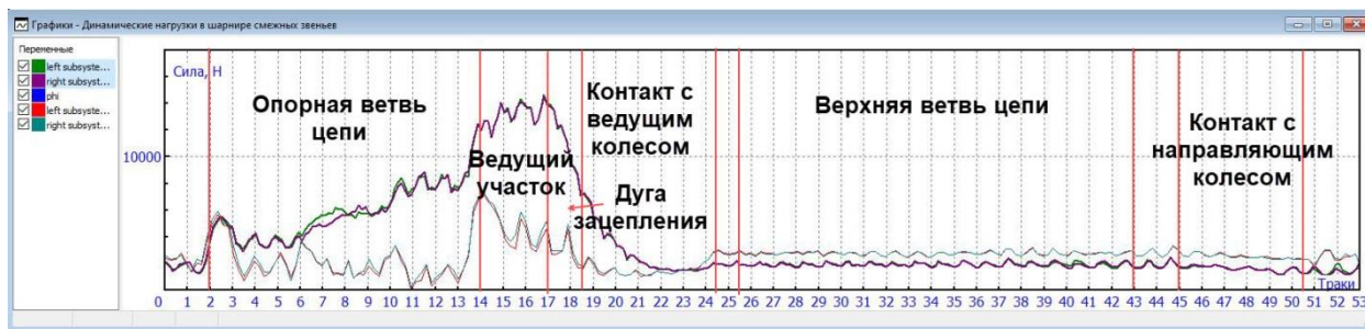
Рис. 35. Анализ графика динамических сил в гусеничном обводе с приложением крюковой нагрузки
