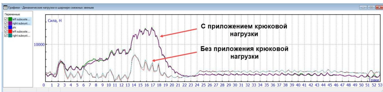
Рис. 31. Графики растягивающих усилий между звеньями гусеничной цепи с приложением крюковой нагрузки
