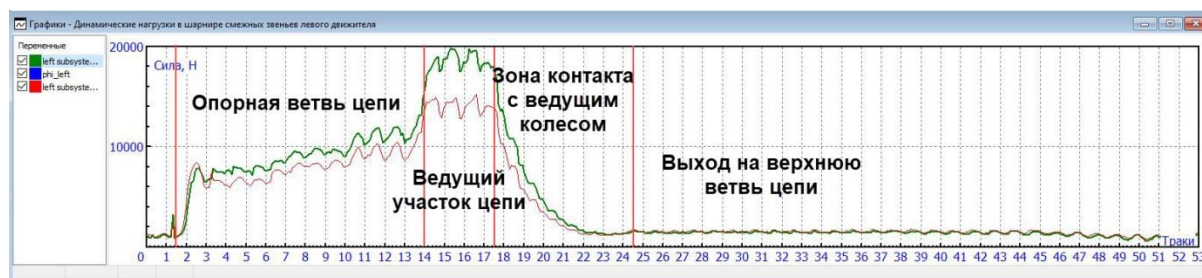
Рис. 38. Анализ графика динамических сил в левом гусеничном обводе с приложением крюковой нагрузки
