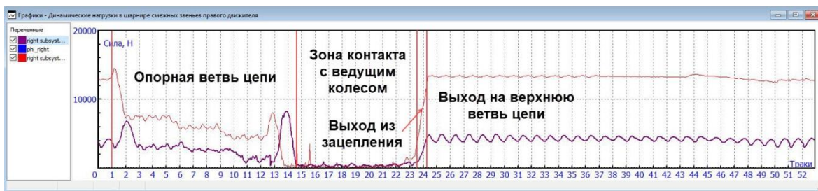
Рис. 39. Анализ графика динамических сил в правом гусеничном обводе в приложении крюковой нагрузки
