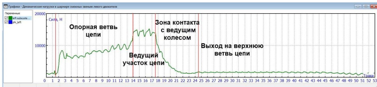
Рис. 21. Анализ графика динамических сил в левом гусеничном обводе
