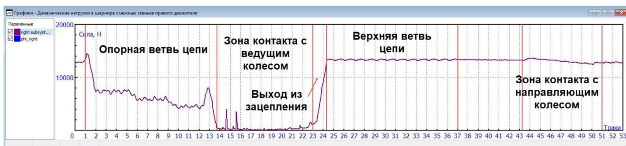
Рис. 22. Анализ графика динамических сил в правом гусеничном обводе
