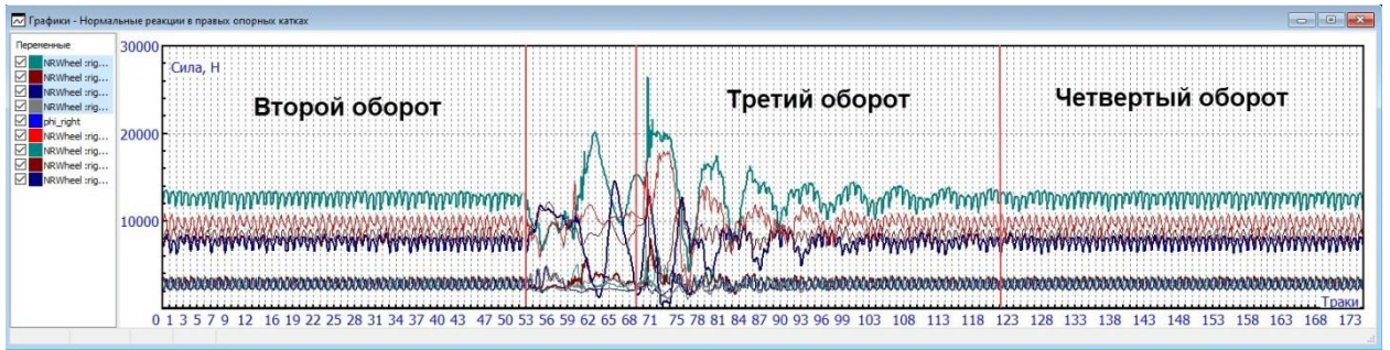
Рис. 35. Графики нормальных реакций в правых опорных катках с приложением крюковой нагрузки
