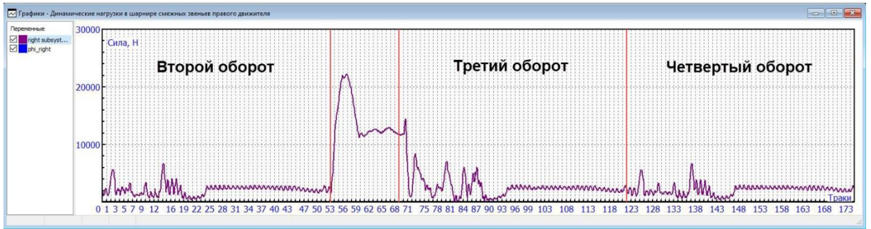
Рис. 18. Графики динамических нагрузок в шарнире между смежными звеньями гусеничной цепи правого движителя
