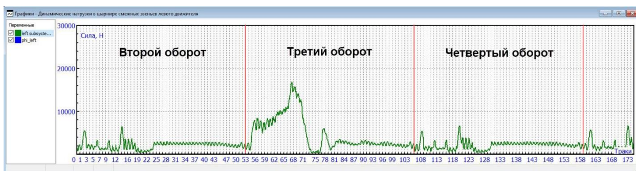
Рис. 17. Графики динамических нагрузок в шарнире между смежными звеньями гусеничной цепи левого движителя
