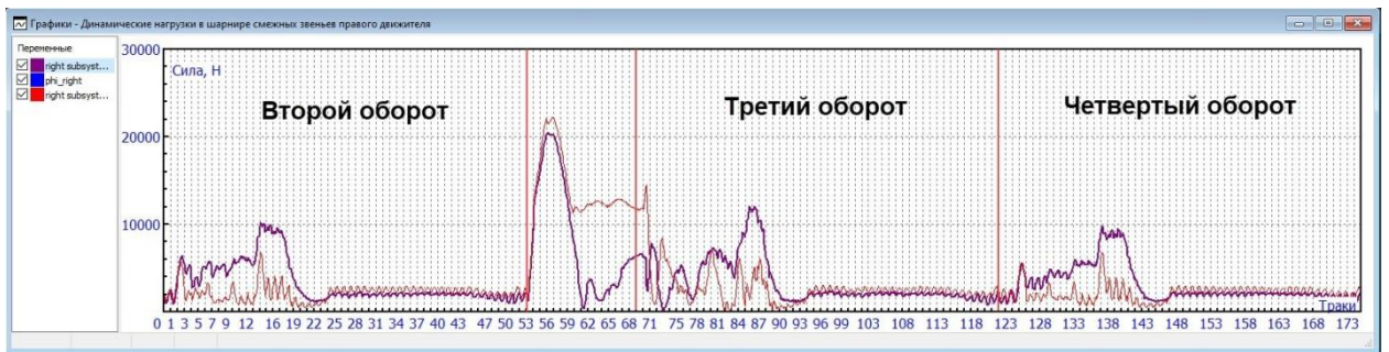
Рис. 33. Графики динамических нагрузок в шарнире между звеньями гусеничной цепи в правом движителе с приложением крюковой нагрузки
