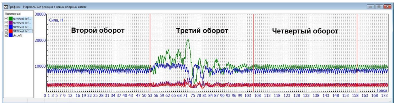
Рис. 19. Графики нормальных сил в левых опорных катках
