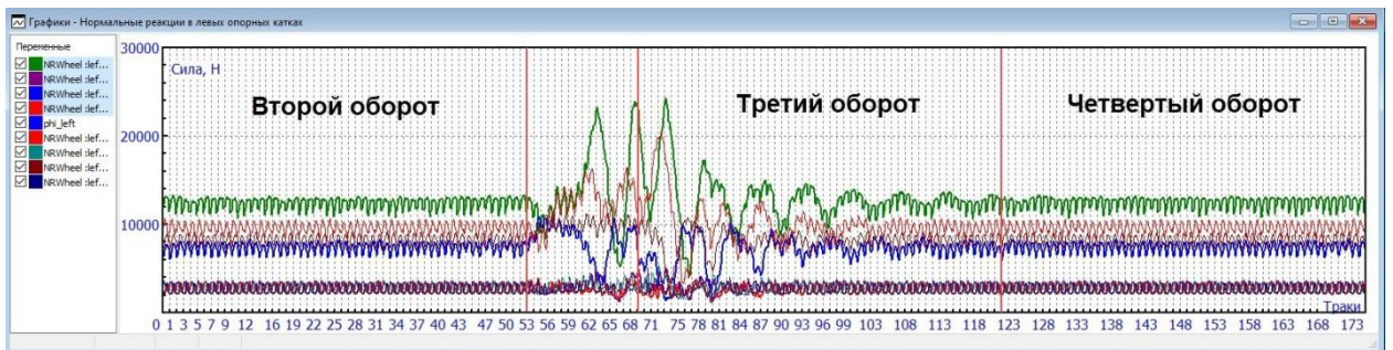
Рис. 34. Графики нормальных реакций в левых опорных катках с приложением крюковой нагрузки
