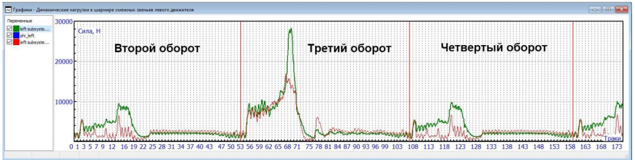
Рис. 32. Графики динамических нагрузок в шарнире между звеньями гусеничной цепи в левом движителе с приложением крюковой нагрузки
